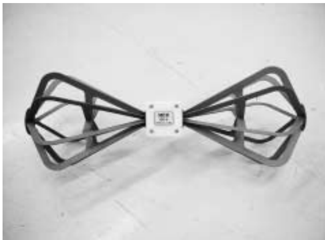
写真2 小型バイコンカルアンテナ（送信用に使用）
