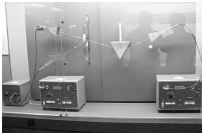
Photo 3 : 電波の反射・屈折・偏波を見る実験装置
