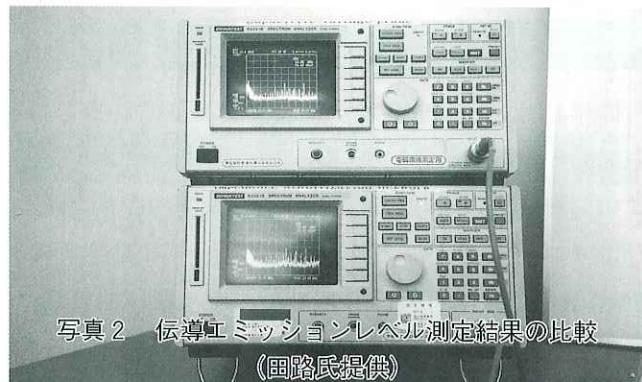
写真2 伝導エミッションレベル測定結果の比較
