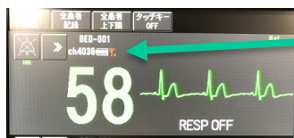
図-6 送信機からの電波強度の表示例
