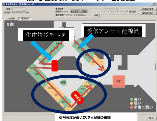
④アンテナの配線経路をプロットし 信号強度が弱いエリアを把握
